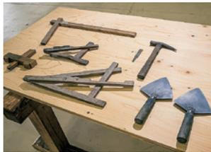
(左から) 施工準備に使用する道具(平瓦谷深選別用、軒丸選別用)や、施工時に使用する勾配定規、タガネ、瓦葺金槌、スルメゴテ。
